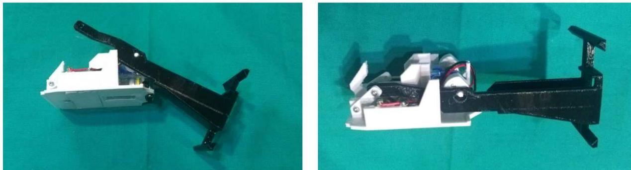
Leg を、crank の凸にかけ（上図の左）、2mm\*8 のタッピングネジを使って、leg と lod を繋ぎます。ネジを締めた後は、半回転程度緩めて leg が自由に動くようにします。この作業を、左右とも2か所行ってください。 Crank と leg の位置合わせしたい時は、スイッチを入れて crank を回し、適当な位置で止めてください。
